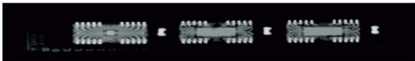
चित्र-5 प्लाज्मा फोकस एक्स-किरण का उपयोग करके कंप्यूटर रैम की रेडियोग्राफी
