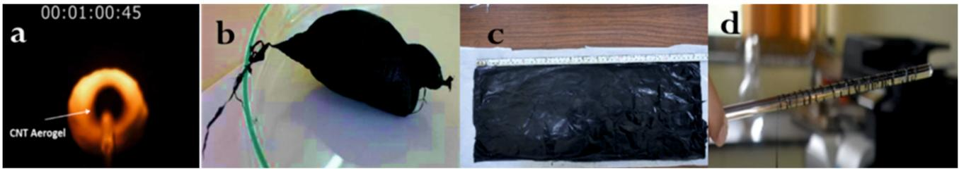
Fig.2: (a) Snapshot of CNT aerogel formation (b) CNT wool (c) CNT sheet (d) CNT fibre.
