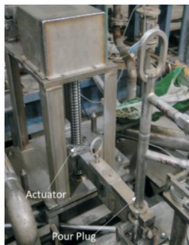
Fig.7: Pour plug actuator.
